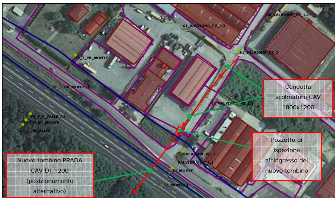
Figura 29. Zona fosso Valvigna - stato progetto con realizzazione di nuovo tombino SP11 e A1 - posizione B.
