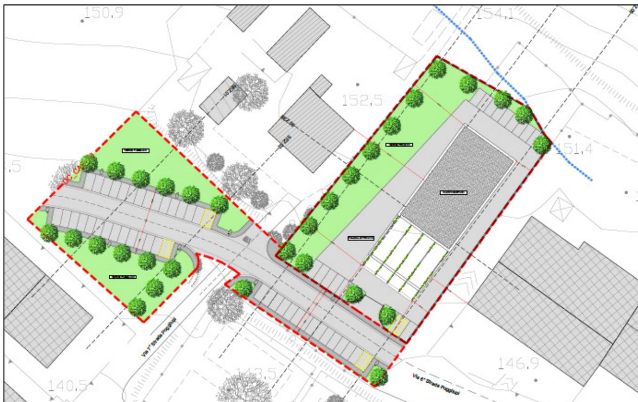
Figura 6: Planimetria di progetto della proposta di Piano Attuativo in variante al R.U.
